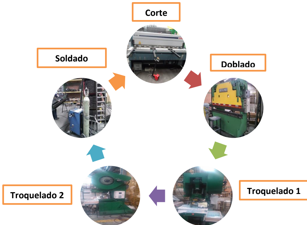
Figura 8. Maquinaria utilizada para la elaboración de Bandeja Portacable en la empresa Peralta Perfilería SAS
